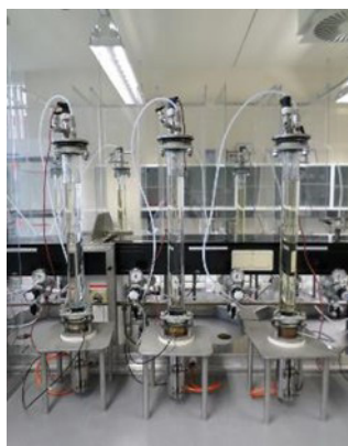
试验装置：ASTM D4340 适应燃料电池的运行工况
